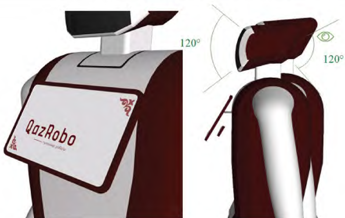
Рис. 2 – Расположение сенсорного экрана и двух камер робота-гуманоида QazRobo
