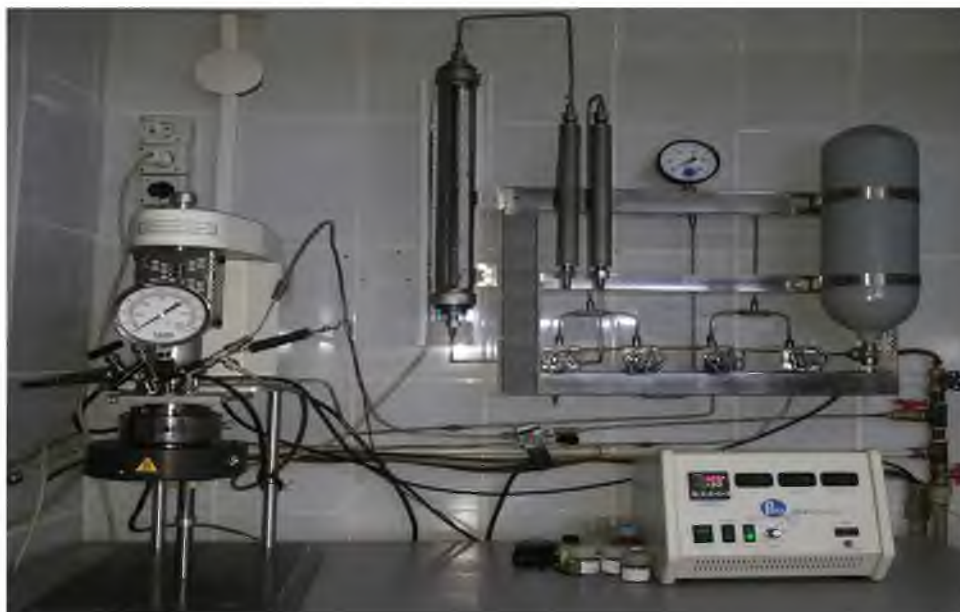
Рис. 1 – Принципиальная схема каталитической установки Parr 4848 для гидрирования под давлением
